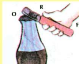
L'ouvre-bouteille est un levier du deuxième genre
