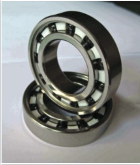
شكل (٢١): يستخدم رولمان البلى في الأجزاء الداخلية للآلات الميكانيكية
