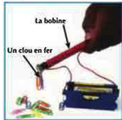
Fig.26 Les trombones sont attirés par le clou quand le circuit électrique est fermé.
