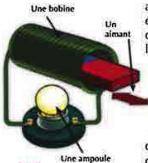
Fig.28 Quand on fait bouger un aimant dans une bobine en fil isolé vers l'intérieur et l'extérieur, un courant électrique est généré dans le fil de la bobine. Ce courant allume une ampoule reliée aux extrémités du fil.
