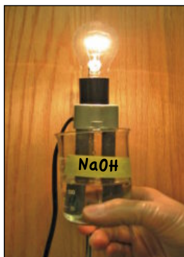
▲ Figure (18) La base forte conduit le courant électrique plus fortement que la base faible
