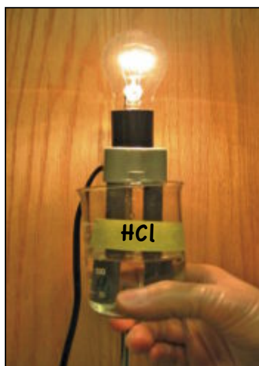
▲ Figure (14) L'acide fort conduit le courant électrique plus fortement que l'acide faible
