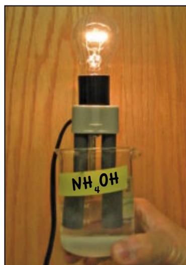
▲ Figure (18) La base forte conduit le courant électrique plus fortement que la base faible
