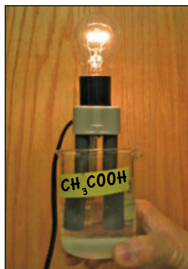
▲ Figure (14) L'acide fort conduit le courant électrique plus fortement que l'acide faible
