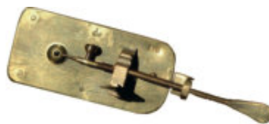
Figure (3) : le microscope du savant van Leeuwenhoek
