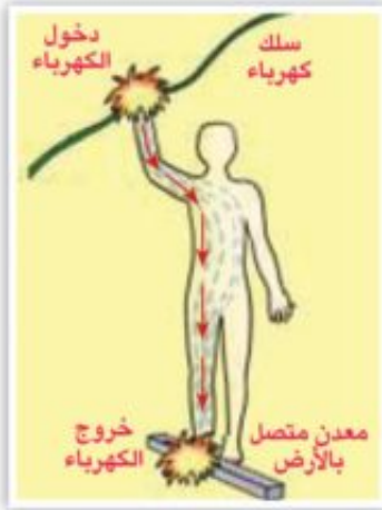
شكل (٢-٢): مرور التيار الكهربى فى جسم الإنسان يؤدى إلى حدوث صدمة كهربية.
